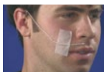
皮膚温度トランスデューサ (BN-TEMP-A-XDCR) 反応時間1.1sec程度 (BN-TEMP-B-XDCR) 反応時間0.6sec程度
