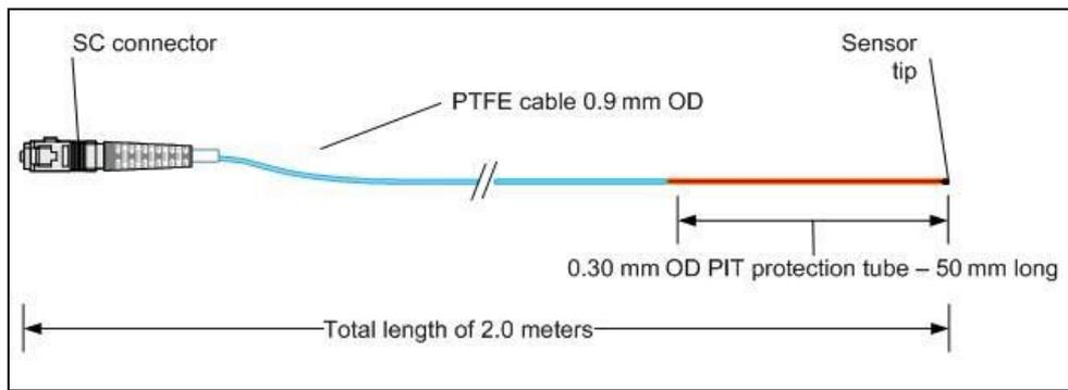
TSD280 と TSD282 MPMS200 用圧力センサーは、MPMS200 システムに直接接続します。
