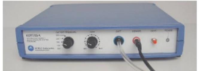
内蔵のポンプで NIBP アンプは、ラットや類似の小動物の尾部の血管を閉塞するために自動的に膨張し、その後膨張点から直線的に圧力を低下させカフゆっくり開放します。一回の操作で、膨張と収縮サイクルの両方を開始します。アンプは、血圧とパルス波形の2つのアナログ出力に加えて、パルス信号を増幅または減衰させるゲイン調整を有しています。収縮、拡張および平均 BP 値です。
