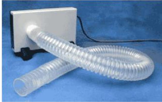
TSD107B は、優れた計測レンジとリニア特性の呼吸流量トランスデューサです。MP システムで TSD107B と DA100C アンプを使用すると、呼吸流量や肺気量に関する様々な計測を行うことが可能です。以下に記載されている機器や適切なソフトウェアのパラメータで、正確な肺気量の測定値を得ることが可能です。
